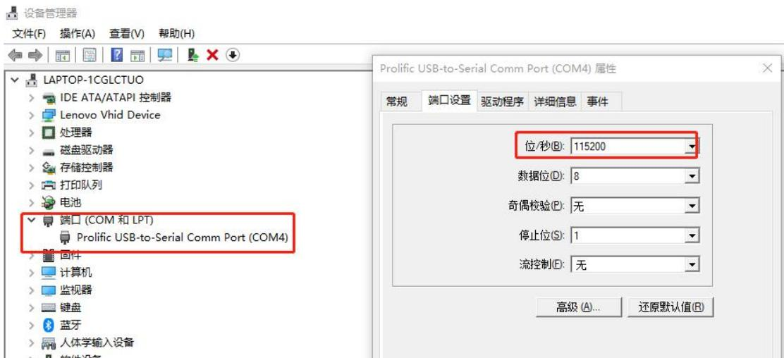
2. 把 USB 转串口线的另一端插到 DarkBird-80G 设备的九针串口上，在管理电脑上用终端程序（比如 SecureCRT）连接串口，接收 DarkBird-80G 的串口输入和输出信息。DarkBird-80G 使用的串口波特率是 115200，串口设置如下：
